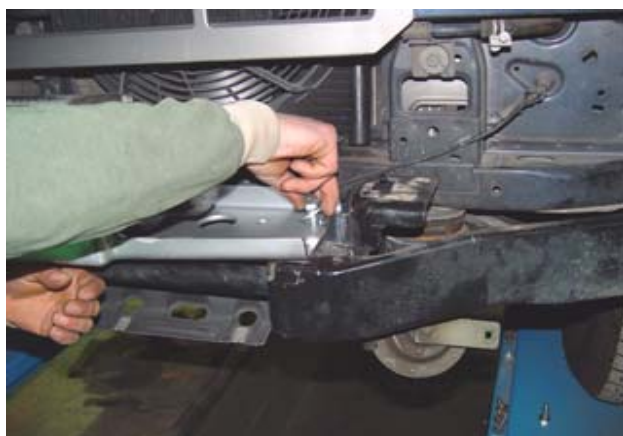
5. Depois de se visualizarem as furações, colocar os Parafusos Cab. Sext. Zn. M12*1,25*30 e respectivas Anilhas M12.
