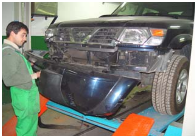
1. Retirar o Pára-choques Frontal de Origem.
