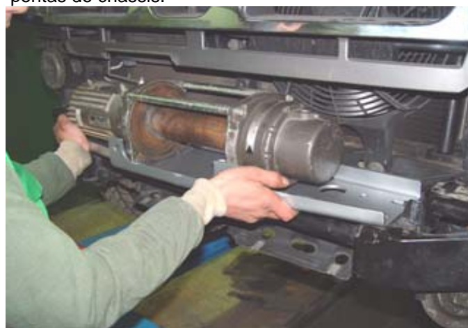
4. Colocar o Guincho em cima da Base, aperta-lo e encostar a mesma até se visualizarem as furações originais por cima das pontas do chassis.
