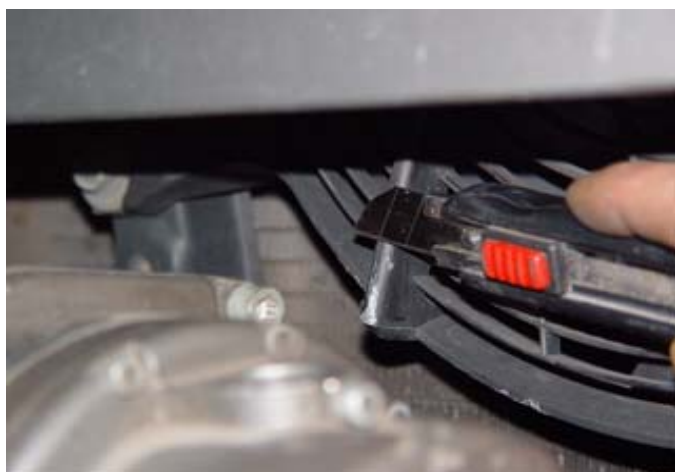
3. Cortar um bocado do plástico da ventoinha, conforme se visualiza na imagem superior.
