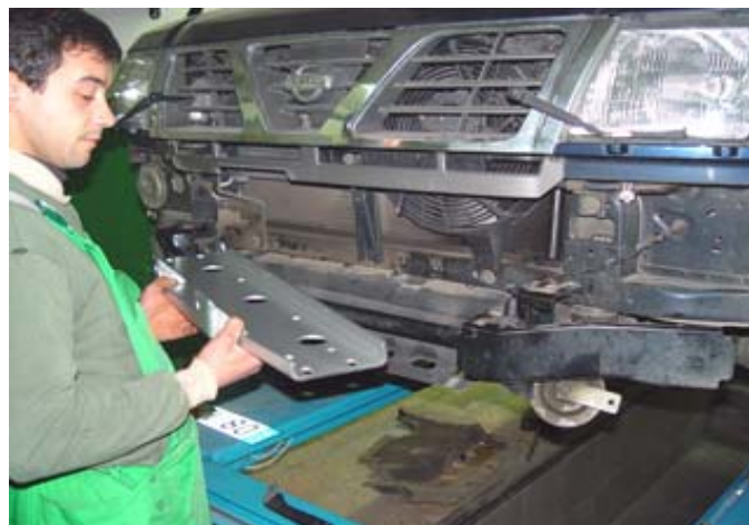
2. Colocar a Base de Guincho na parte superior das pontas do chassis.
