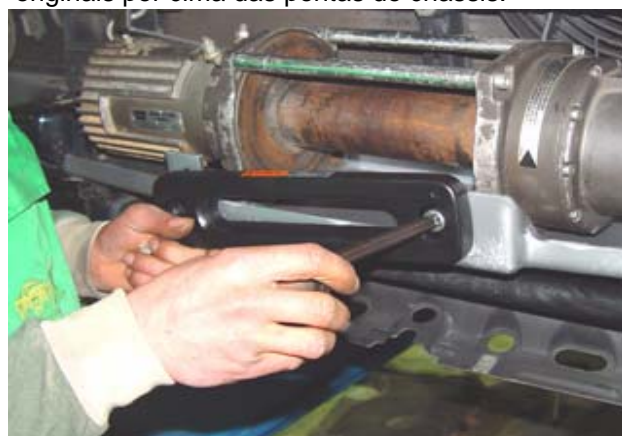
6. Colocar o Guia Simples para Cabo de Aço, e apertar com os Paraf. Cab. Cil. Sext. Int. M12*30. Agora, efectuar o reaperto de todos os Parafusos.
